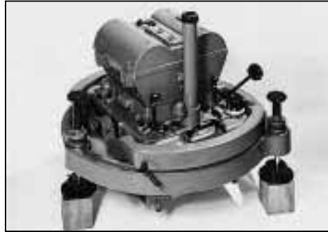
Ein Wild Produkt, das weltweit neue Akzente in der Photogrammetrie setzte: die anfangs der 40er-Jahre entwickelte, vollautomatische Reihenbild-Messkammer RC5.
