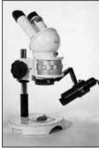
Stereomikroskop Wild M4A: Dieses einfache Instrument mit Trommelvergrößerungswechsler kam 1967 auf den Markt.
