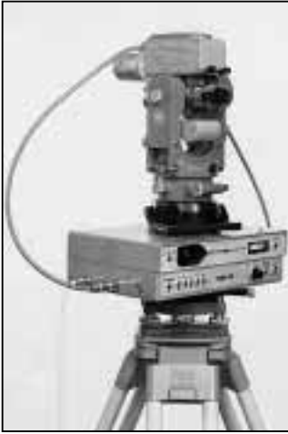
Als Bestseller erwies sich 1973 der IR-Distanzmesser DISTOMAT DI3. Nach Eingabe des Vertikalwinkels zeigt er sofort die Horizontalabstand und den Höhenunterschied an.
